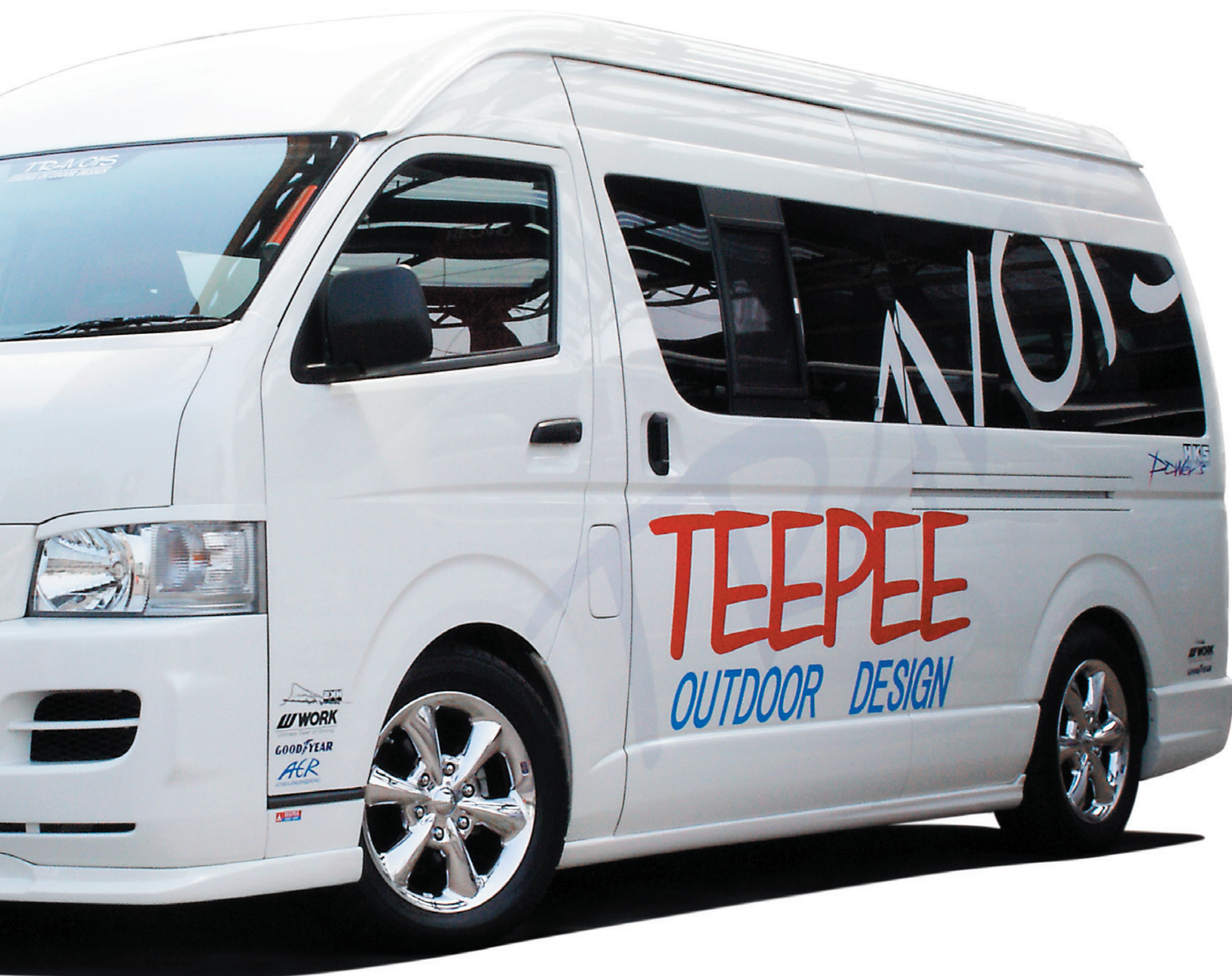
[SIZE] FRONT:17inch×6.5JJ INSET38mm TIRE:215/60-17 REAR:17inch×6.5JJ INSET38mm TIRE:215/60-17 COLOR:ワークブラックメタルコート (WBC) ※フェンダー加工
