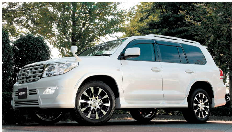
[SIZE] 20inch × 9.5JJ INSET 55mm TIRE : 275/55-20 COLOR : ブラックカットクリア (BP) ※フェンダー加工
