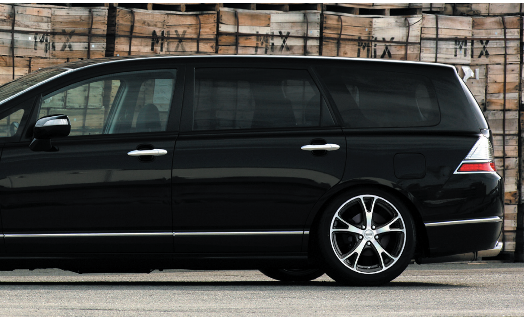
【SIZE】FRONT:18inch×7.0JJ INSET53mm TIRE:225/45-18 REAR:18inch×7.0JJ INSET53mm TIRE:225/45-18 COLOR:ブラックカットクリア (BP) ※フェンダー加工
