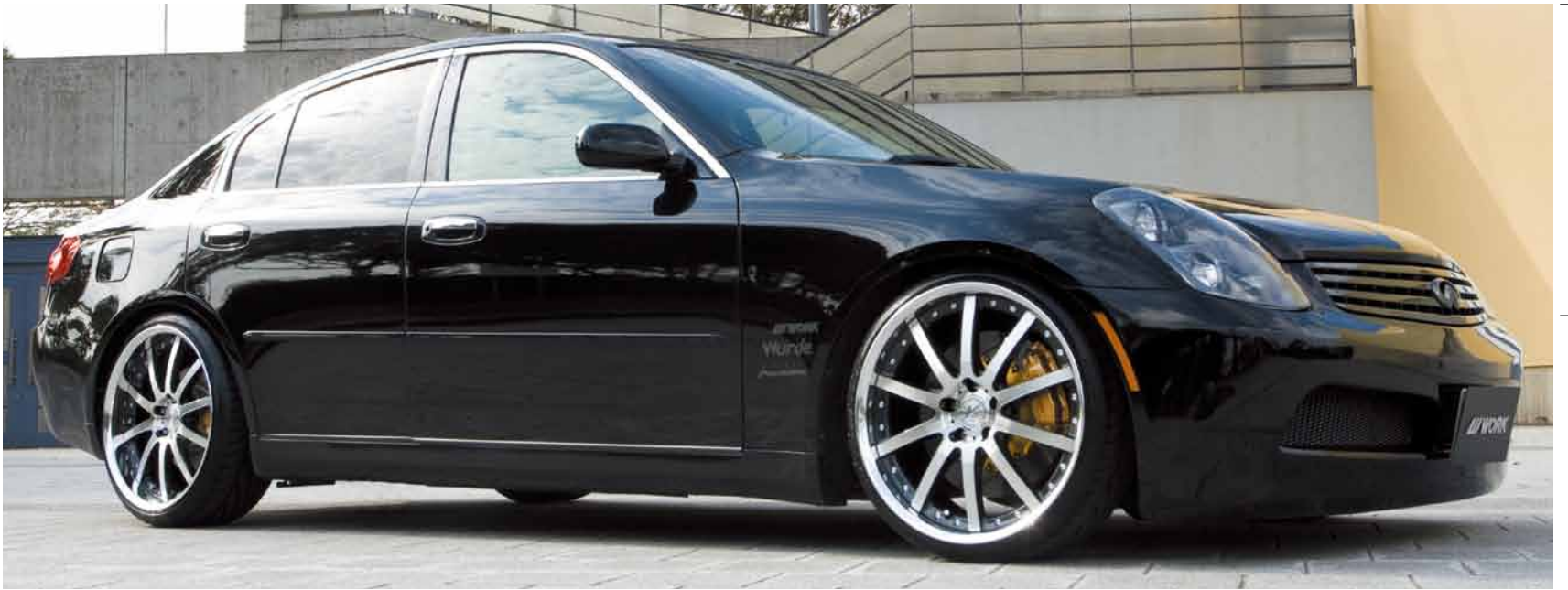
[SIZE] FRONT : 20inch x 8.5JJ INSET 28mm (R) TIRE : 225/30-20 REAR : 20inch x 9.5JJ INSET 36mm (O) TIRE : 245/30-20 COLOR : ガンメタリックカットクリア (GMP2) ※フェンダー加工
