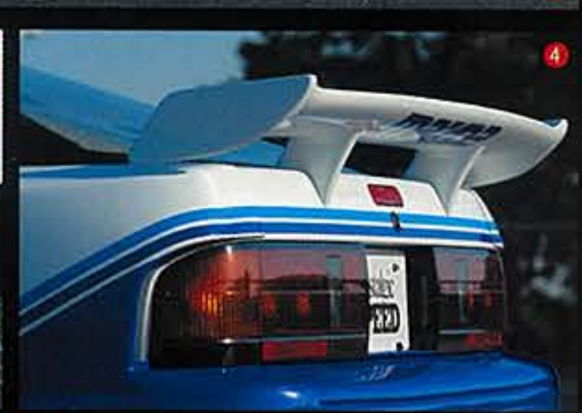
③ 車両は後期型だが、フロントバンパーに合わせて前期仕様になっている。ボンネットはガレージカゴコニ製。 ④ ややトランクより後ろにマウントされたスタイリッシュなウイングはKSPエンジニアリングのドラッグレース用。 ⑤ JSS仕様のフェンダーには給油口がないため、プリスターフェンダーに合わせて内部を成形。最初からこうだったかと思えるようなスマートな仕上げ。 ⑥ JSS仕様のエアロはエンジンがNAのため、本来インタークーラーの装着を前提としていない。そのため造形を一部加工して対応。
