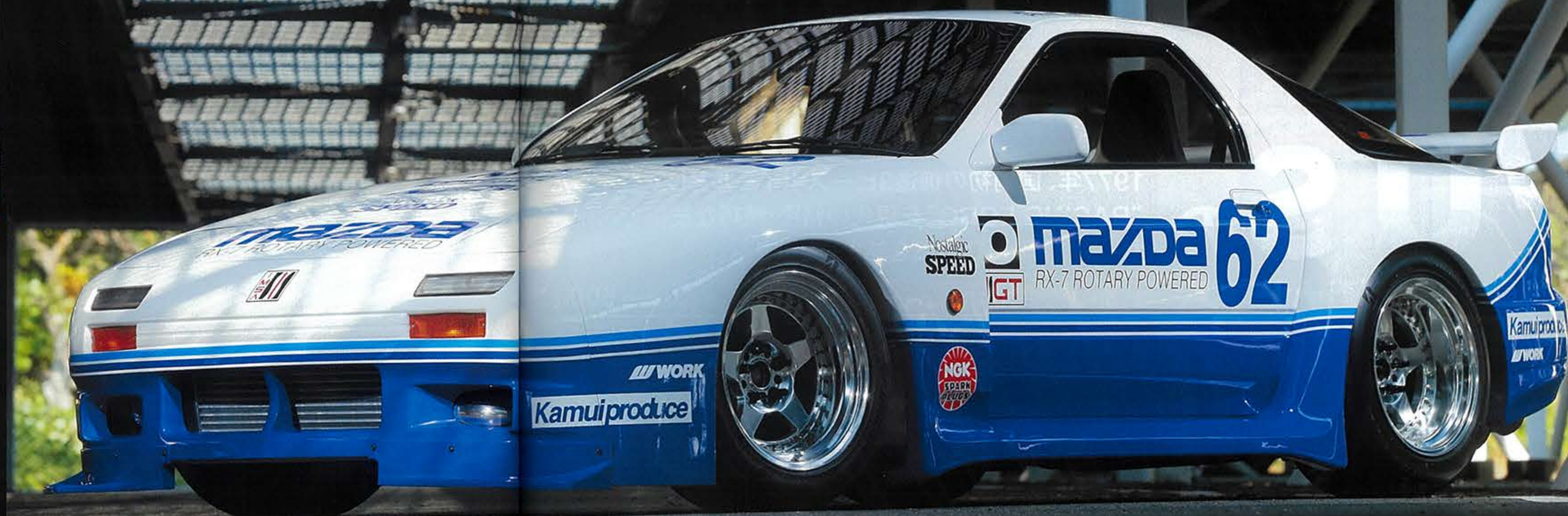
③ 車両は後期型だが、フロントバンパーに合わせて前期仕様になっている。ボンネットはガレージカゴコニ製。 ④ ややトランクより後ろにマウントされたスタイリッシュなウイングはKSPエンジニアリングのドラッグレース用。 ⑤ JSS仕様のフェンダーには給油口がないため、プリスターフェンダーに合わせて内部を成形。最初からこうだったかと思えるようなスマートな仕上げ。 ⑥ JSS仕様のエアロはエンジンがNAのため、本来インタークーラーの装着を前提としていない。そのため造形を一部加工して対応。
