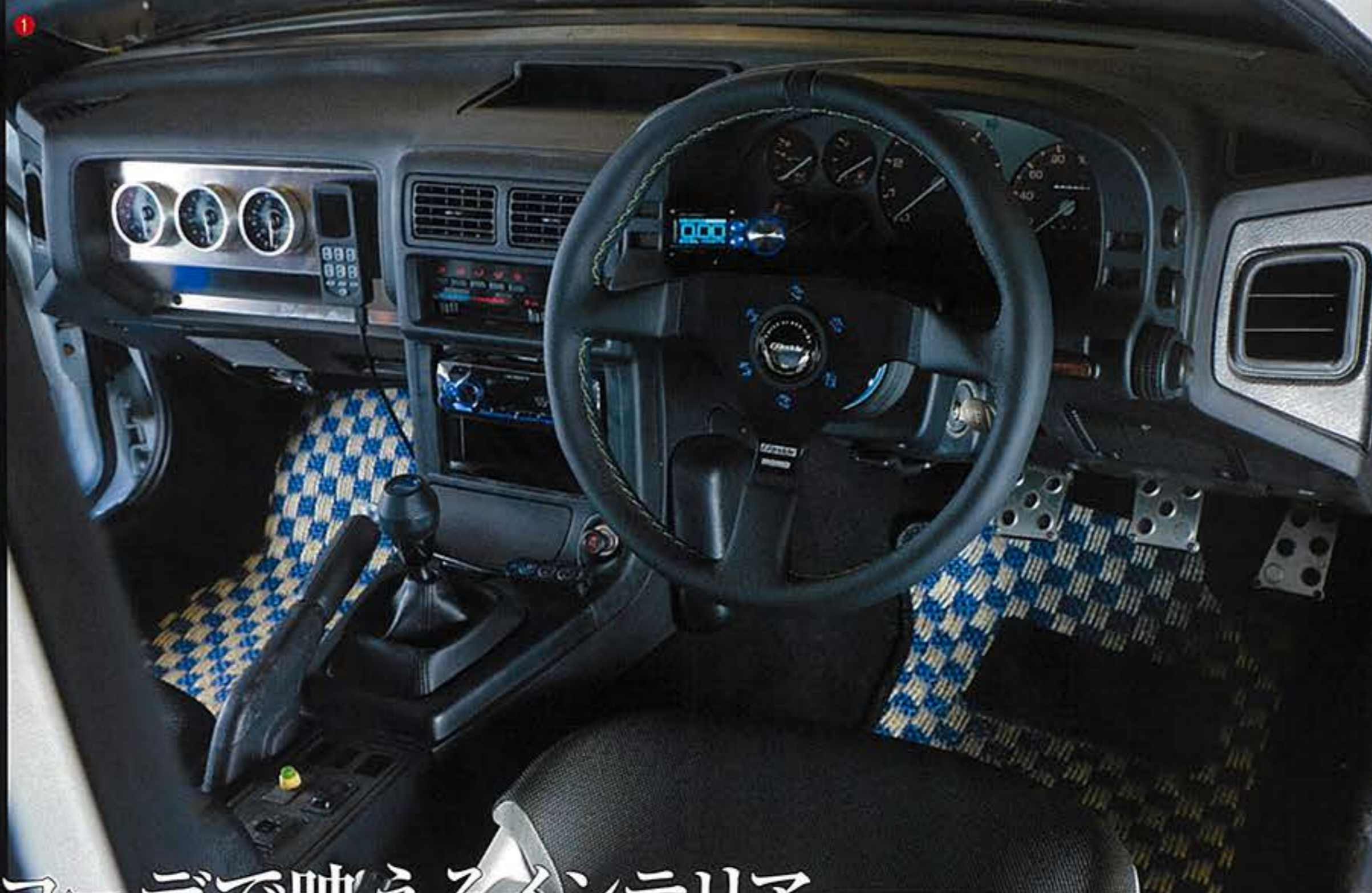
①ノーマル然としながらもボディカラーに合わせた色を加えることで統一感を出す。ステアリングはGReddyとMOMOがコラボした限定100本のコラボ品。ステアリング奥に見えるのはGReddyのブーストコントローラーのプロフェック。②助手席グローブボックスのヘアラインパネルは、ウイングタケオ製。左から油圧、油温、水温。隣に見えるのはエアサスの車高調用操作コマンダー。③シフトノブもGReddy製で、フロアマットはKARO製だ。
