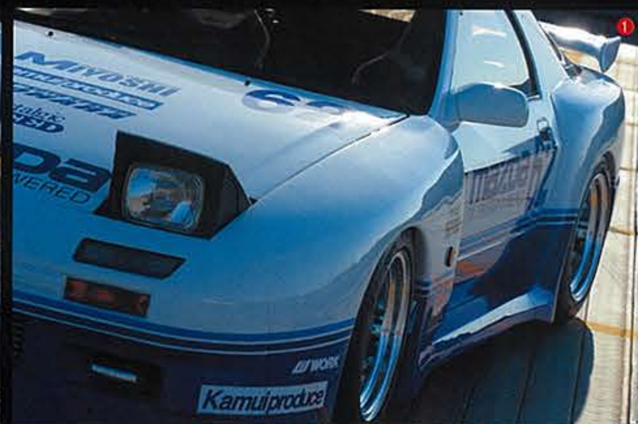
①② 埼玉のERC製ボディキットより、全幅は約200mm拡大。丸みのあるプリスターフェンダーが迫力のあるスタイリングを構築。現行レースカーと比べると空力デバイスも控えめで、時代を感じさせる。
