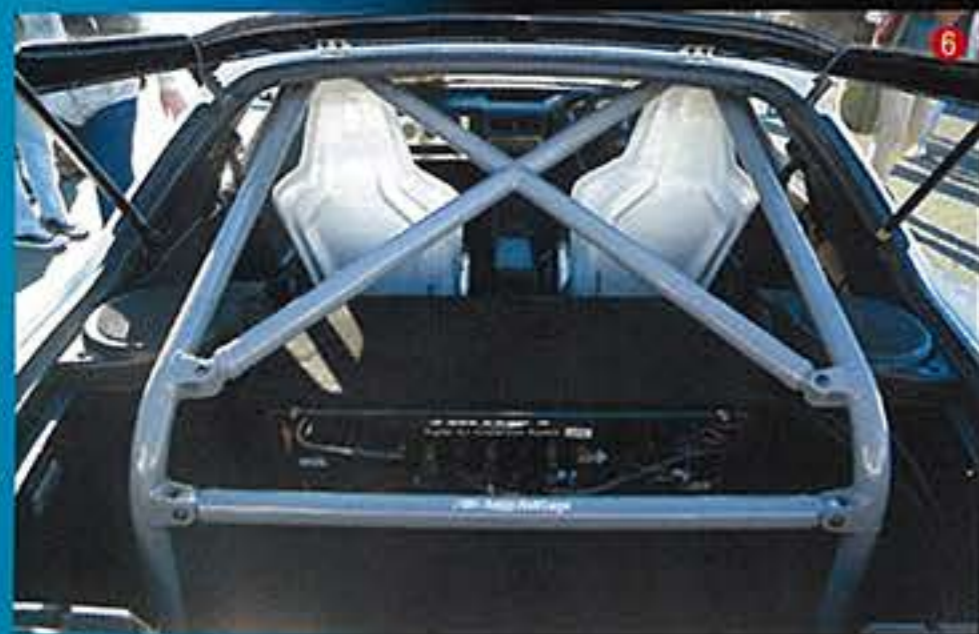
④フルバケットシートながらストリート&ファッション性を意識した人気のRECARO製RCSを運転席、助手席にセット。ただし4点式シートベルトの装着は不可。 ⑤ラゲージルームにあるボックスは、エアレックス製エアサスのメインユニット。サイズに合わせてオーダーしたかのようにキレイに収まる。 ⑥レースカーを想起させるために、斜行ロールバーも装着。実用性をスポイルさせないため、リアのみの設定。
