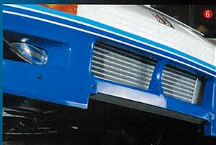
③ 車両は後期型だが、フロントバンパーに合わせて前期仕様になっている。ボンネットはガレージカゴコニ製。 ④ ややトランクより後ろにマウントされたスタイリッシュなウイングはKSPエンジニアリングのドラッグレース用。 ⑤ JSS仕様のフェンダーには給油口がないため、プリスターフェンダーに合わせて内部を成形。最初からこうだったかと思えるようなスマートな仕上げ。 ⑥ JSS仕様のエアロはエンジンがNAのため、本来インタークーラーの装着を前提としていない。そのため造形を一部加工して対応。
