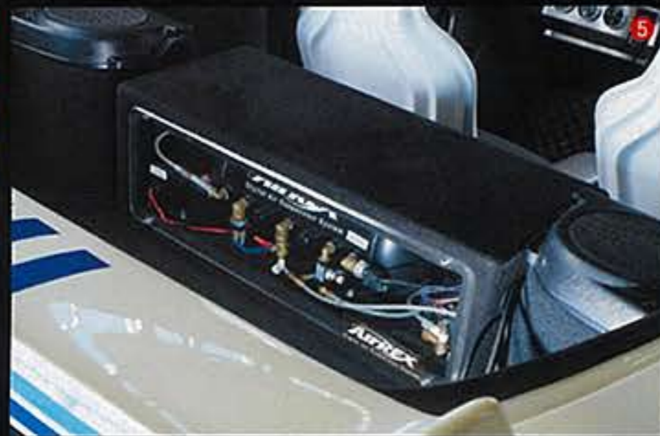
④フルバケットシートながらストリート&ファッション性を意識した人気のRECARO製RCSを運転席、助手席にセット。ただし4点式シートベルトの装着は不可。 ⑤ラゲージルームにあるボックスは、エアレックス製エアサスのメインユニット。サイズに合わせてオーダーしたかのようにキレイに収まる。 ⑥レースカーを想起させるために、斜行ロールバーも装着。実用性をスポイルさせないため、リアのみの設定。
