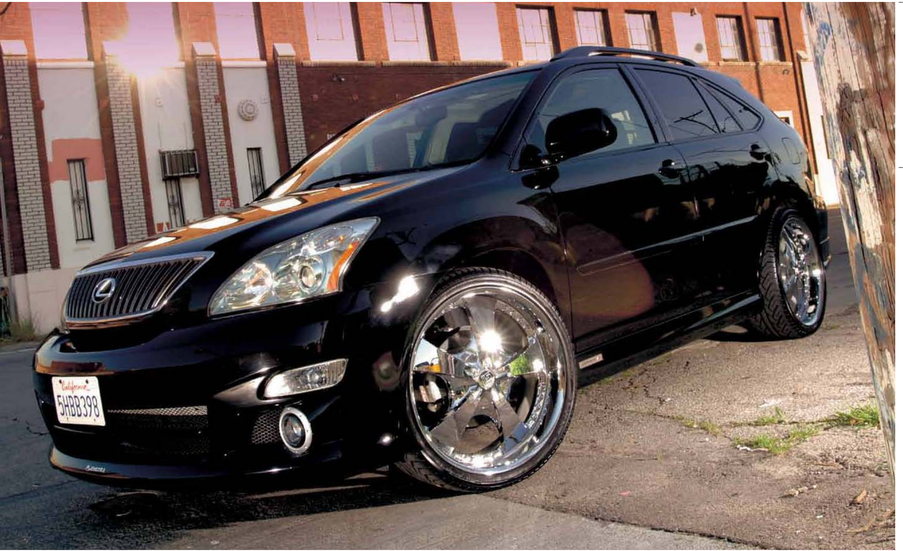
[SIZE] FRONT : 22inch x 9.0JJ INSET 26mm (O) TIRE : 275/30-22 REAR : 22inch x 9.0JJ INSET 26mm (O) TIRE : 275/30-22 COLOR : スーパークロームメッキ (SC) ※フェンダー加工
