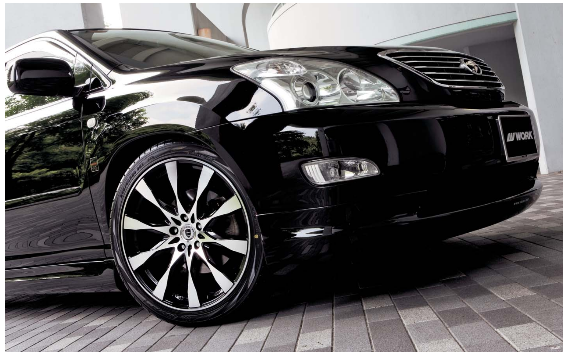
[SIZE] FRONT: 20inch×8.5J INSET28mm TIRE: 245/40-20 REAR: 20inch×8.5J INSET28mm TIRE: 245/40-20 COLOR: ブラックカットクリア (BP) ※フェンダー加工
