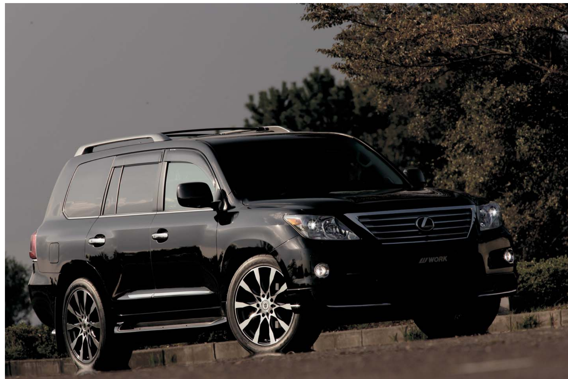
【SIZE】 22inch x 10.0J INSET 50mm TIRE : 305/40-22 REAR : 22inch x 10.0J INSET 50mm TIRE : 305/40-22 COLOR : ブラックカットクリア (BP) ※フェンダー加工
