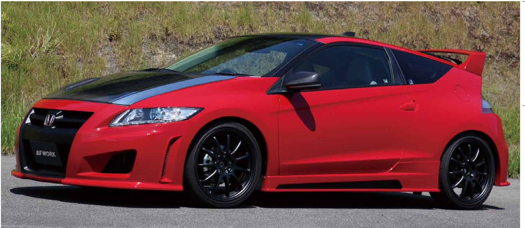
[SIZE] FRONT : 18inch x 7.5JJ INSET 47mm (ST) TIRE : 215/40-18 REAR : 18inch x 7.5JJ INSET 38mm (ST) TIRE : 215/40-18 COLOR : マットブラック (MBL) ※フェンダー加工
