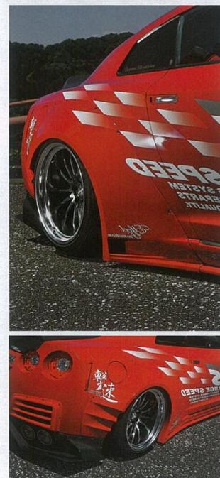
サイドステップ部分までも覆うリヤオーバーフェンダーは片側70mmワイドの設定。後端下部はカーナーブ形状としてシャープなディテールとし、リヤに向かってボディを絞り込むと共に、リヤバンパードクトとのデザイン共通化も図っているのが分かる。
