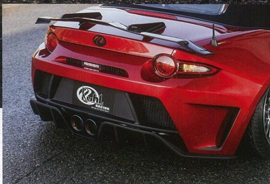
ロードスターのスタイルを損なわない内巻き形状しながら、深い奥行きとサイドダクトにより、スポーティ&ワイド感を感じさせるデザインのリヤバンパー。ディフューザーは空力を意識した吊り下げ形状とし、レーシングスタイルを創出する。
