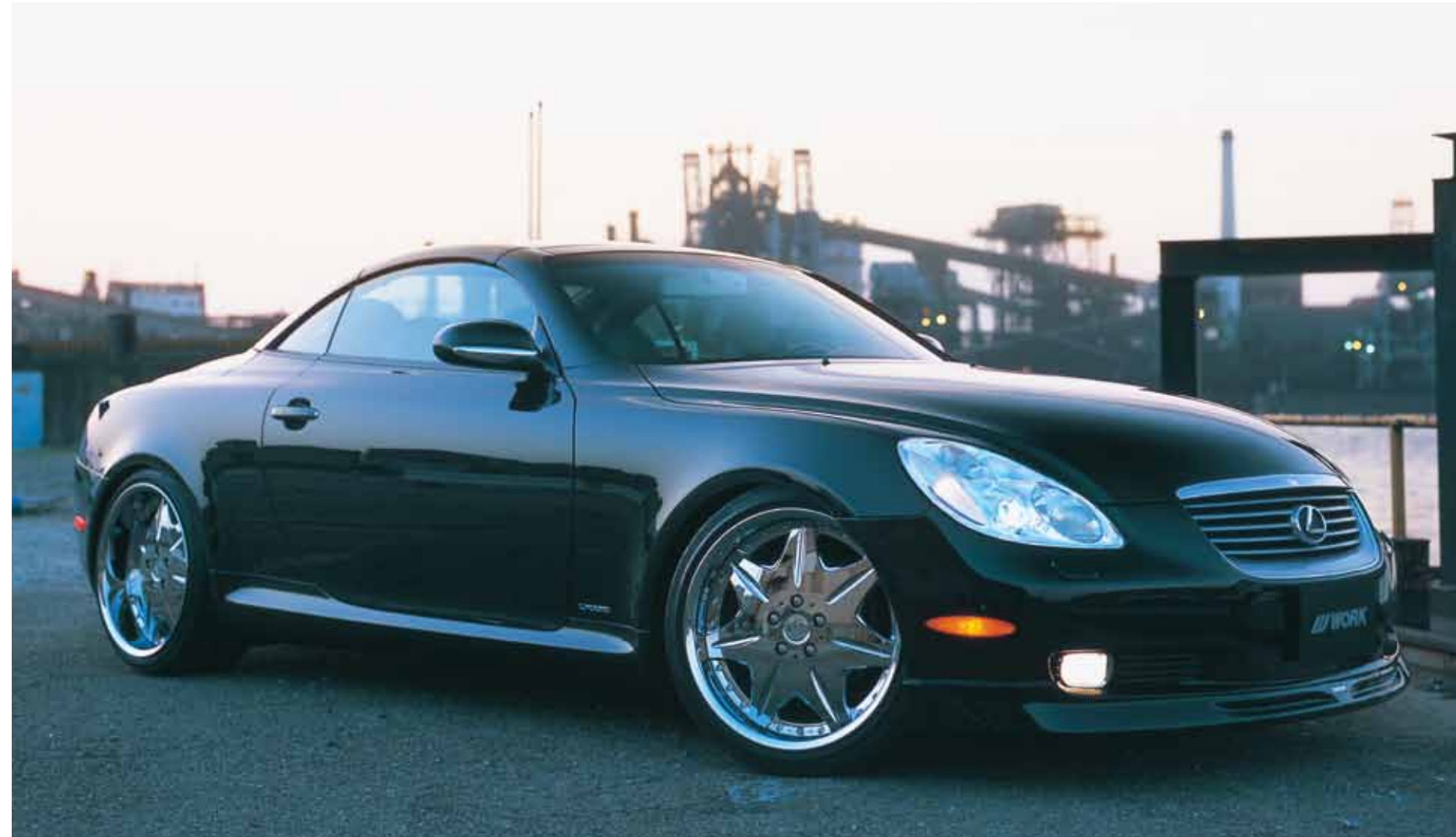
[SIZE] FRONT : 19inch x 9.0J INSET 38mm (A) TIRE : 245/35-19 REAR : 19inch x 10.5J INSET 26mm (O) TIRE : 275/30-19 COLOR : スーパークロームメッキ (SC) *フェンダー加工
