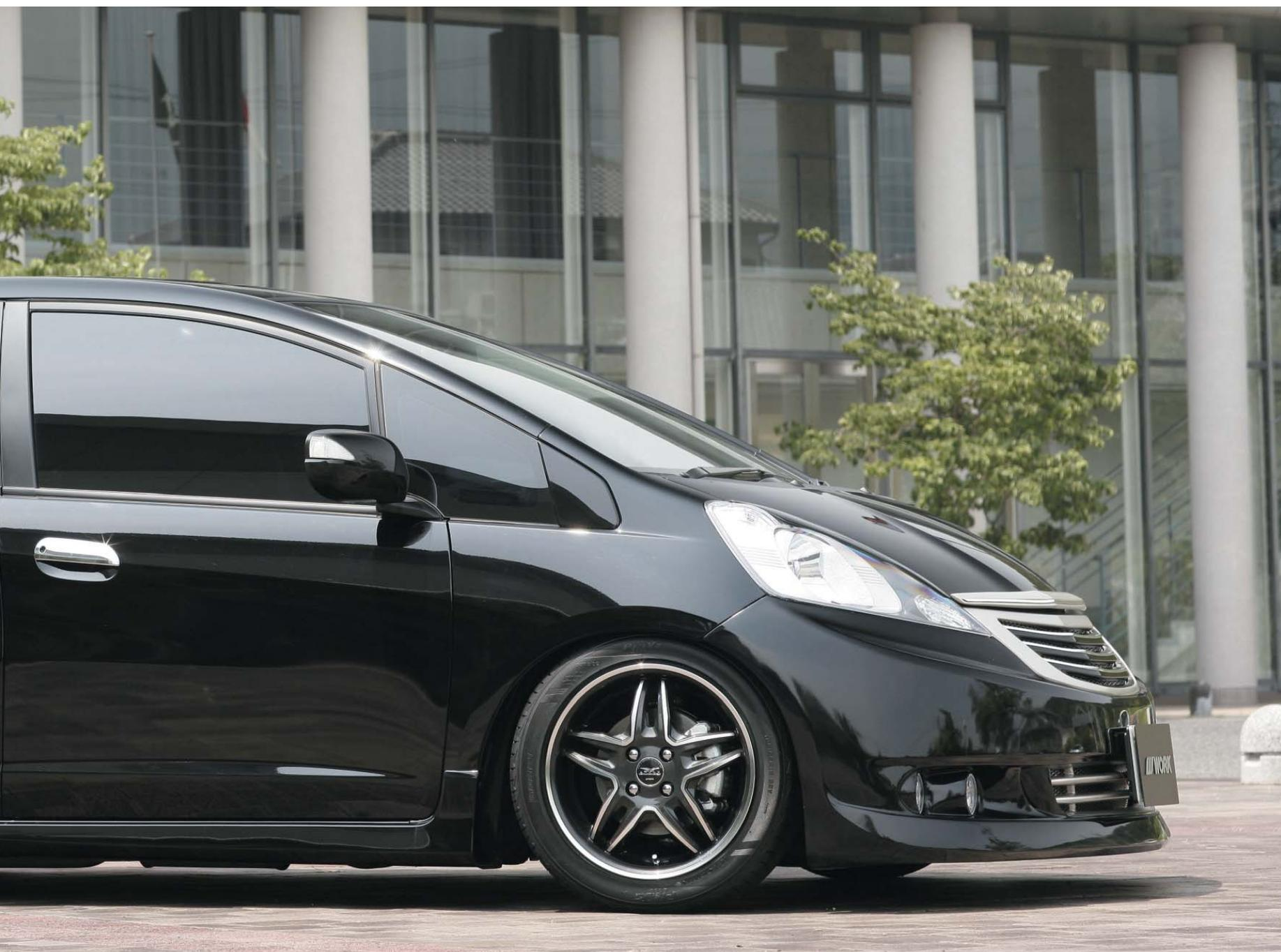
【SIZE】 FRONT : 16inch×6.5JJ INSET50mm TIRE : 185/55-16 REAR : 16inch×6.5JJ INSET50mm TIRE : 185/55-16 COLOR : ガンブラックカットクリア (GKP) ※フェンダー加工
