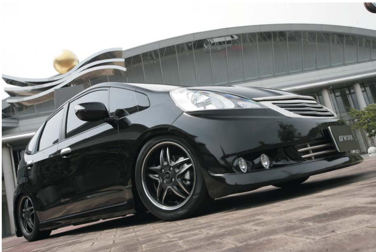
【SIZE】 FRONT : 16inch×6.5JJ INSET50mm TIRE : 185/55-16 REAR : 16inch×6.5JJ INSET50mm TIRE : 185/55-16
