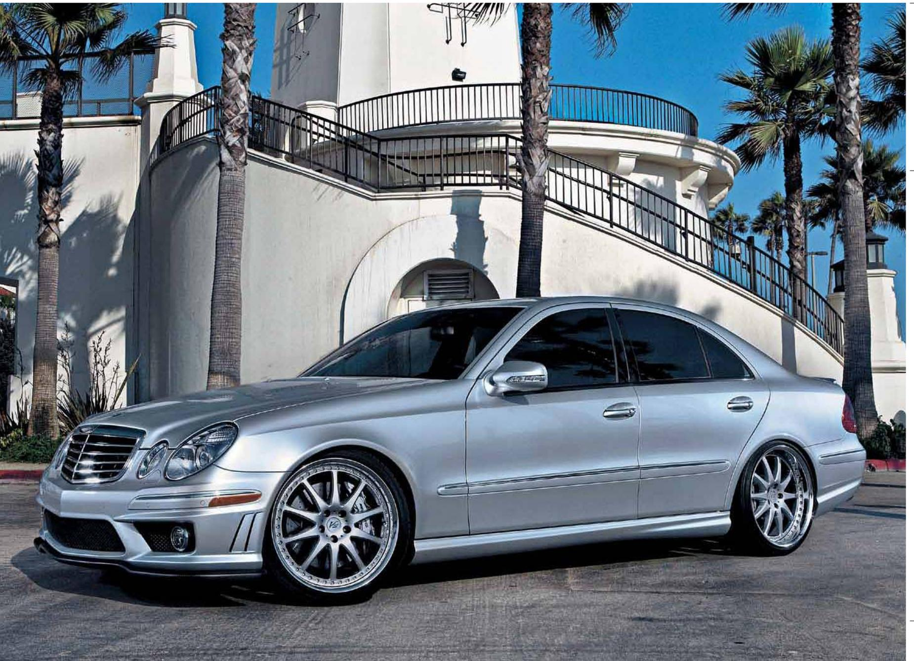
[SIZE] FRONT : 20inch x 9.0JJ INSET 36mm (R) TIRE : 245/35-20 REAR : 20inch x 10.5JJ INSET 38mm (O) TIRE : 275/30-20 COLOR : ファインハイトシルバーⅡ (FS2) ※フェンダー加工
