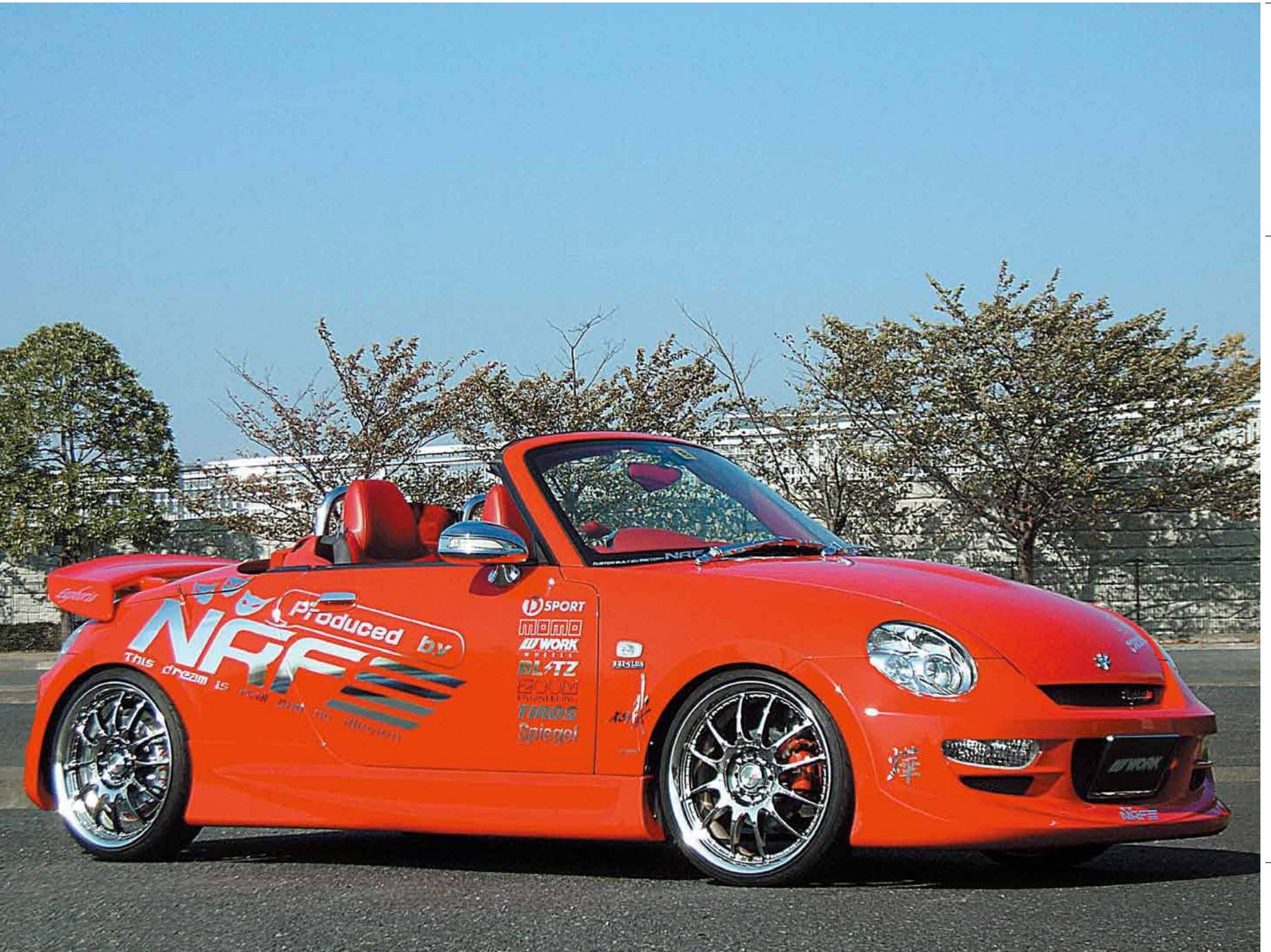
[SIZE] FRONT : 17inch x 6.0JJ INSET 45mm (W) TIRE : 165/40-17 REAR : 17inch x 6.0JJ INSET 38mm (W) TIRE : 165/40-17 COLOR : ワークブラックメタルコート (WBC) ※フェンダー加工
