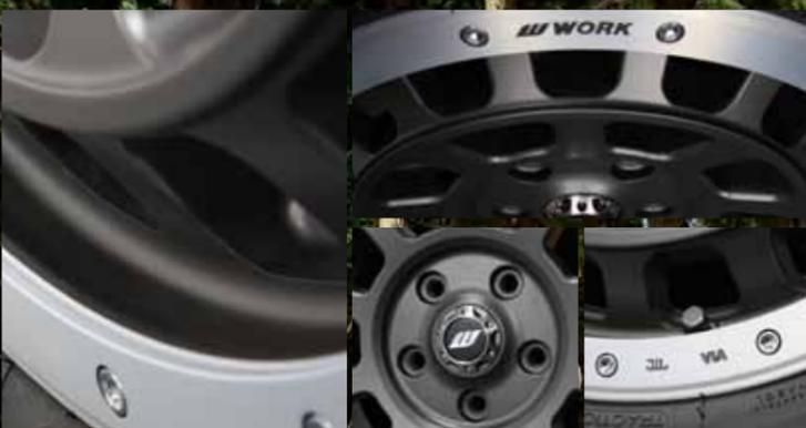
センター部の彫りを限界までティーパーフューン化。中心部の薄肉化と軽量化を実現した。フランジカット面のピラスはビードロックリングを固定するホルドを液状の外周部を一段下げることで、フランジとタイヤの間に石や泥を詰まりにくくする効果を持たせている。
