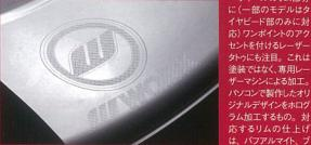
ホイールのリム部分に(一部)のモデルはタイヤビード部のみに付属)ワンポイントのアクセントを付けるレーザータトゥにも注目。これは塗装ではなく、専用レーザマシンによる加工。パソコンで製作したオリジナルデザインをホログラム加工するもの。対応するリムの仕上げは、パフアルミ・ナ
