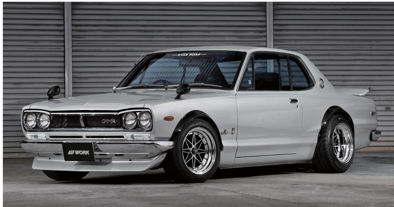
[SIZE] FRONT : 15inch x 9.0J INSET-28mm(T) TIRE : 195/55-15 REAR : 15inch x 10.5J INSET-47mm(T) TIRE : 225/50-15 COLOR : ブラックカットクリア (BP)
