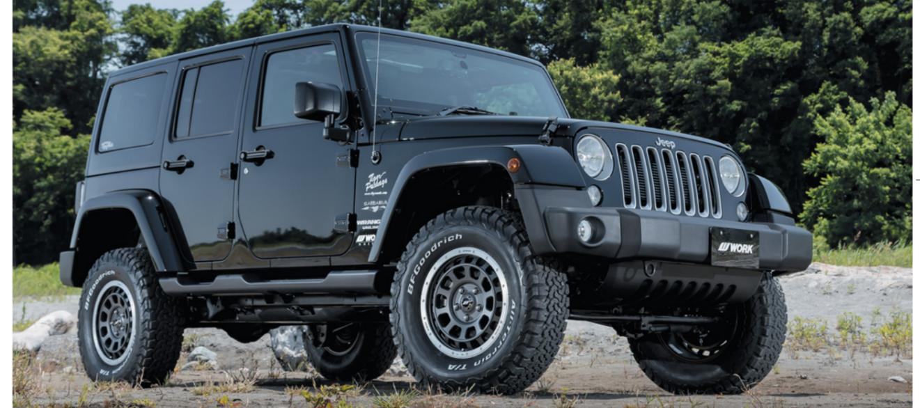
[SIZE] FRONT : 16inch × 7.0J INSET 38mm TIRE : 235/70-16 REAR : 16inch × 7.0J INSET 38mm TIRE : 235/70-16 COLOR : アッシュドチタンカッターリム (AHGRC)
