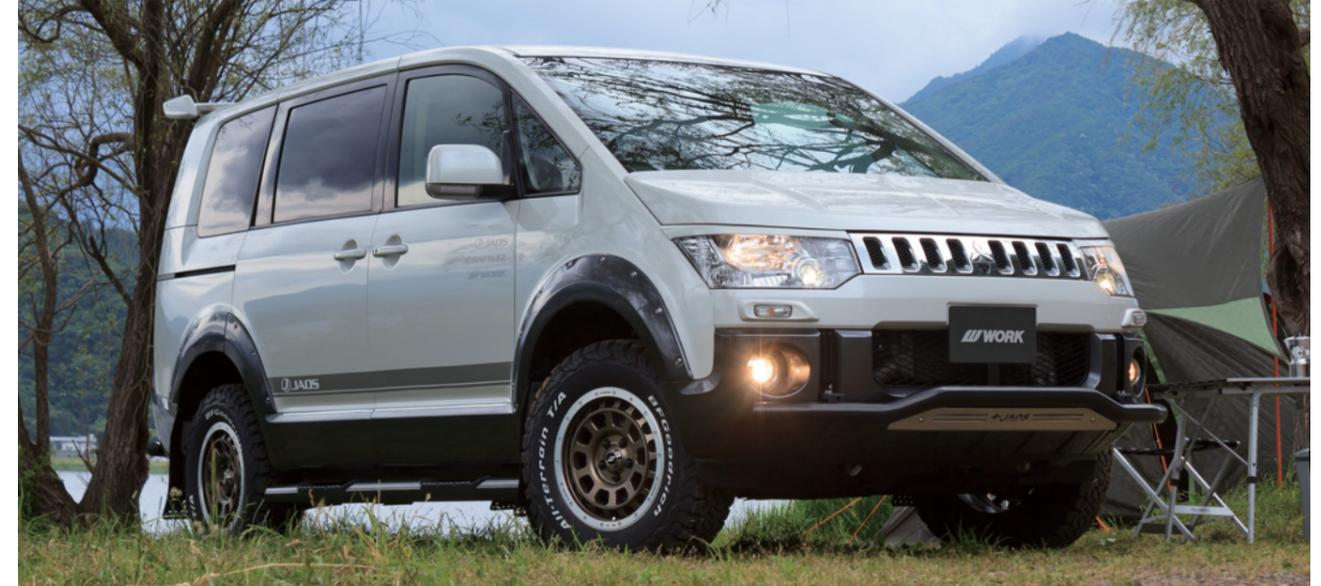
[SIZE] FRONT : 16inch × 5.5J INSET 20mm TIRE : 175/80-16 REAR : 16inch × 5.5J INSET 20mm TIRE : 175/80-16 COLOR : マットカーボンカッターリム (MGMRC)
