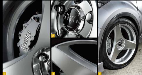
①シンプルな3本スポークデザインは、アフターのキャリパーカバーといったドレスアップパーツを装着した際に"見せる"効果も抜群だ。②センターのナットホール周辺を可能な限りコンパクトに設計し"足長スポーク"を表現。③スポークの存在感を際立てるため側面のエリアはペイントで仕上げる。下地にグレー、表面に微小なメタリックを配合し上質な印象を作り出す。④従来から同シリーズに共通する処理法だったアンダーカット部の切削ラインはあえて無くしてシンプル化。これにより特徴的な3本スポークをさらに際立たせた。
