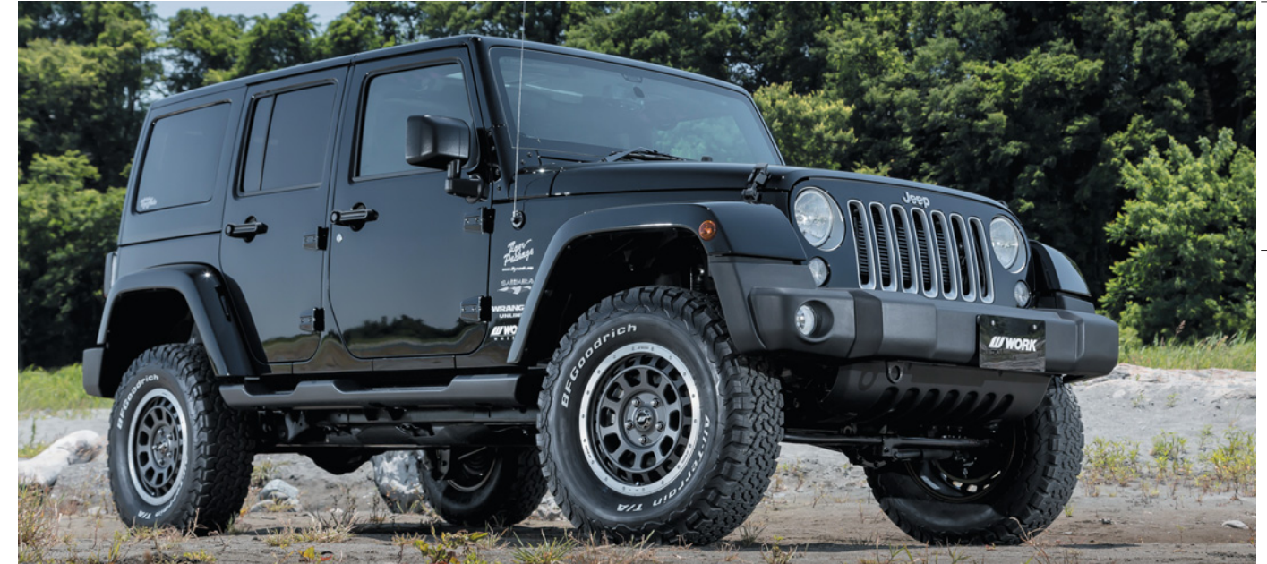
[SIZE] FRONT : 17inch × 7.0J INSET 38mm TIRE : 34 × 10.50R17 REAR : 17inch × 7.0J INSET 38mm TIRE : 34 × 10.50R17 COLOR : マットカーボンカットリム (MGMRC)
