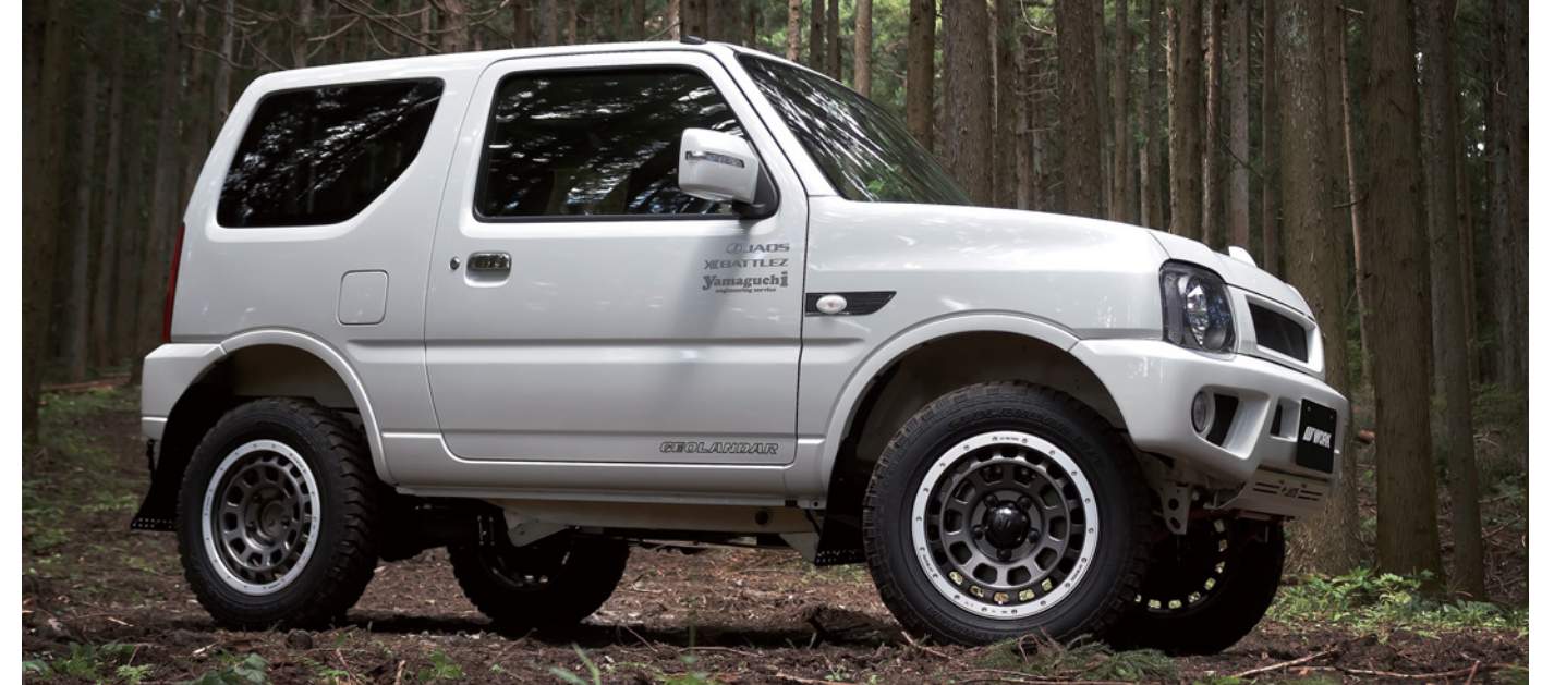
[SIZE] FRONT : 16inch × 5.5J INSET 20mm TIRE : 175/80-16 REAR : 16inch × 5.5J INSET 20mm TIRE : 175/80-16 COLOR : マットカーボンカットリム (MGMRC)
