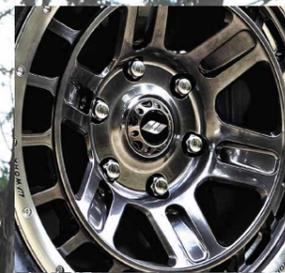
センターキャップ自体小径だが、ナット回りの座面もT-グラビックに比べ、小径かつスポークからの落ち込みは約10mm深い。アウトサイドスポーク付け根のリングから座面までの高低差も今回の装着サイズでは64mm差と、一層コンケイブ感を際立たせた(数値はいずれも今回の装着サイズ、17×8.0J+20の場合)。
