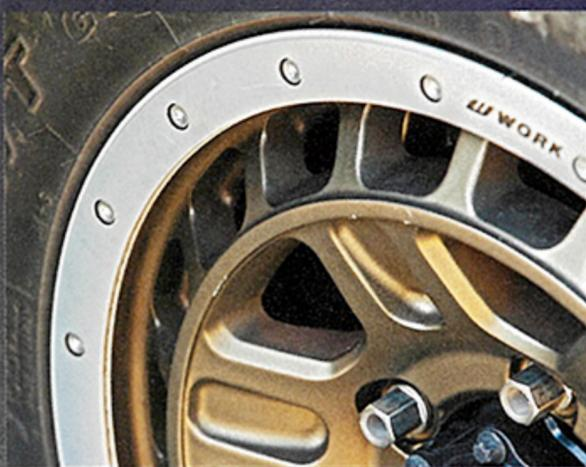
WORK 渾身のオフロードホイールだとうかがい知れるディスクデザインは、アウトサイドスポークとインサイドスポークのダブルスポーク構造となり、やはり T-グラビックのテイストを踏襲。本作 T-グラビック 2 ではアウトサイドスポークをシェイプ化、さらにインサイドスポークの開口部も大きくした上でディンプルを設けた。ベースとなるスペシャルホイールの原型を忠実に再現することで、高剛性を保持しながら、軽量化にも貢献している。
