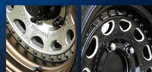
ディスク中央には「CROSS OVER RACING GEAR」文字が鋳抜きでシャープに刻まれる。なお、デリカD:5 などに対応する 5H-114.3 サイズにはセンターキャップが付属している。
