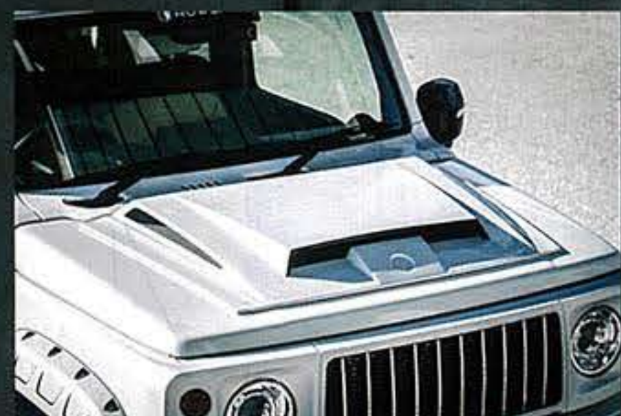
エッジを効かせたボンネットフードカバーは、前と左右にダクトを配置したスポーティな造形を見せつける。
