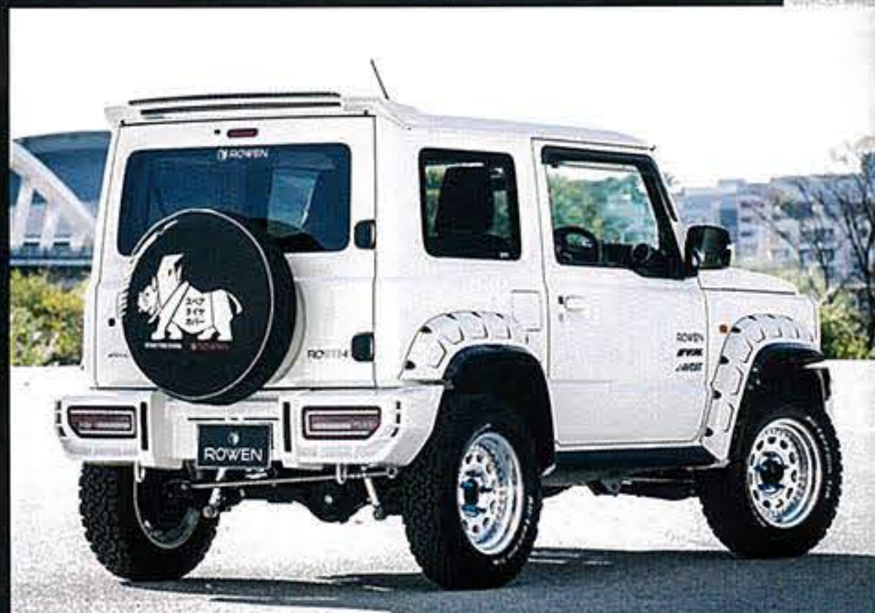
左右にタテ3連、ナンバー横にスリット状のダクトを配置。フロント同様凝ったデザインのリアバンパー。
