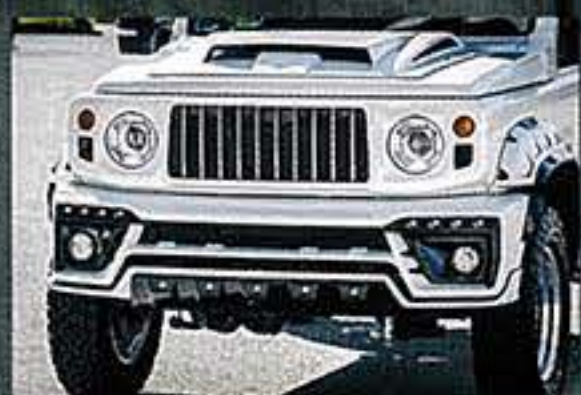
ロエンらしい凝ったデザインのフロントバンパー。左右ダクトのLEDはシーケンシャルウインカー化が可能だ。
