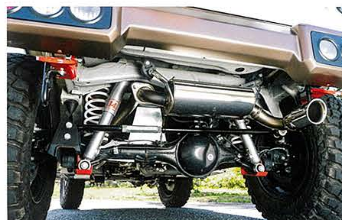
減衰力調整式のダンパーを採用した60ミリアップサスペンション。各種補正作業をしっかりと行い、乗り心地と走行性能を確保している。
