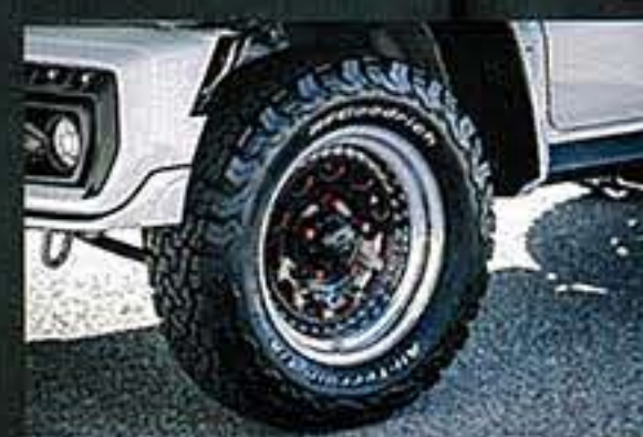
ホイールはクラッグ・ガルバトレ(16×5.5J-19)。タイヤはBFグッドリッチKO2(215/70R16)を組み合わせる。
