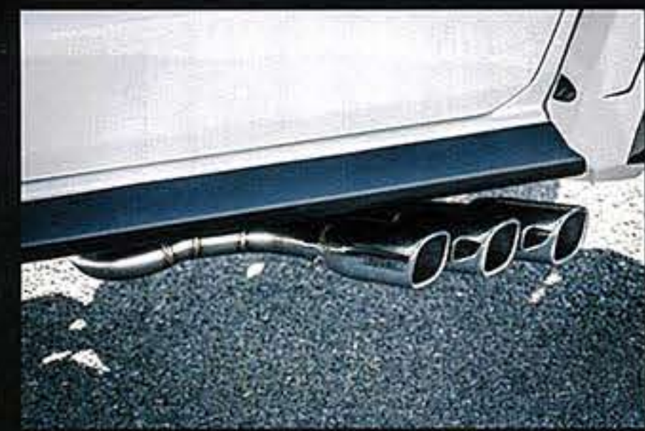
スクエアテールを採用した左側サイド3本出しのスポーティなマフラーは、プレミアム01Sマフラー。純正のセンターから後を交換するタイプで、車検対応の予定。ステンレス製。
