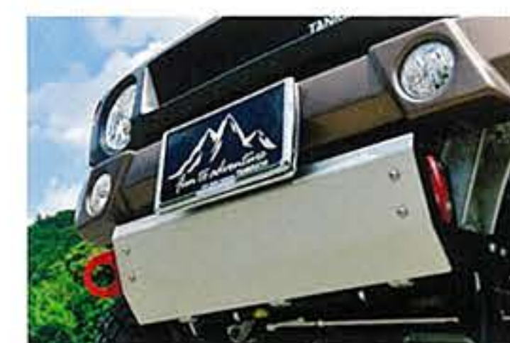
しっかりとした牽引フックとスキッドプレートを装備。穴あけ加工を必要とせず、最強レベルに強固な作りだ。見た目のインパクトも抜群。
