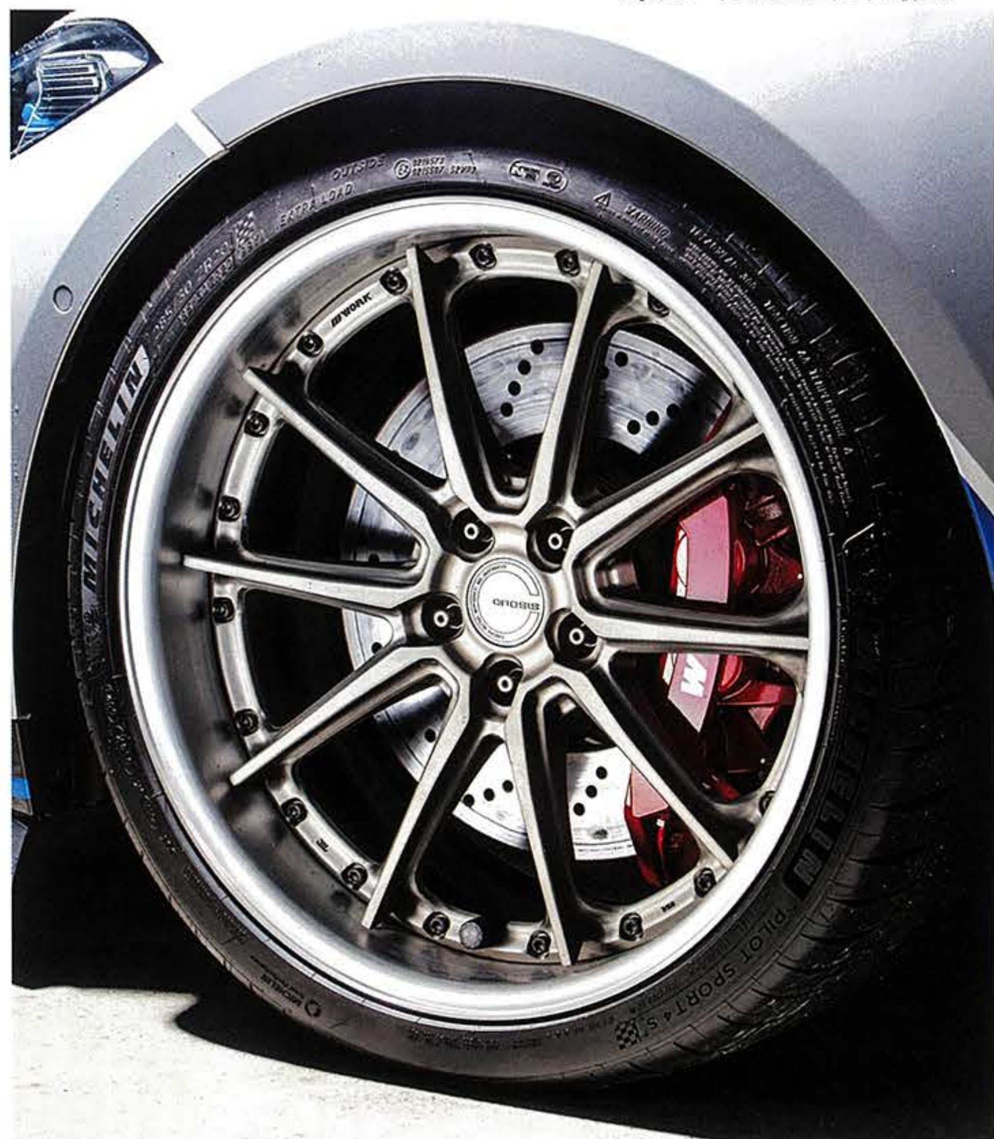
↓フロントが20インチで、リアが21インチ。フロントは純正オプションより1インチアップ。ブレーキシステムがキレイに収まる
