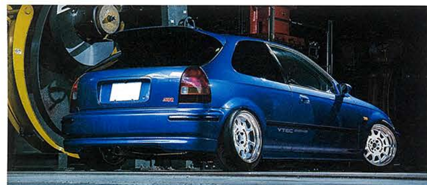
アーチラインに対してのバランスも考慮して205/45R16を履くイーブライム・EK4は、スポークディッシュとタイヤの逞しで足元を引き立てたシンプルレーシーな1台。タイヤ外径から生まれる腰高感は車高の低さでカバーすべく、フロント9J×16+20、リア9J×16+15の引っ張りマッチングによってクリアランスを確保している。
