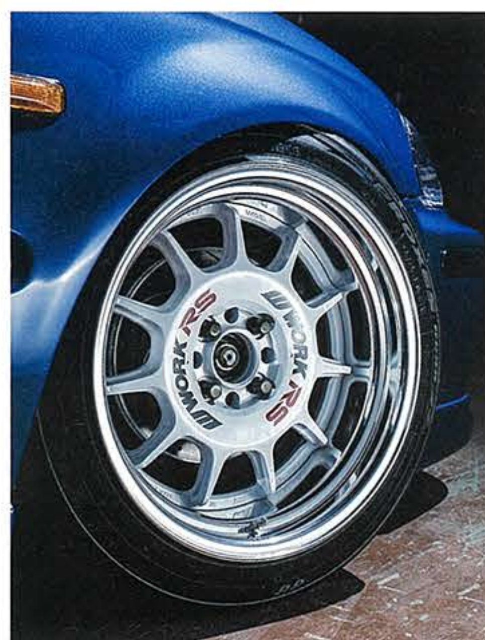
アーチラインに対してのバランスも考慮して205/45R16を履くイーブライム・EK4は、スポークディッシュとタイヤの逞しで足元を引き立てたシンプルレーシーな1台。タイヤ外径から生まれる腰高感は車高の低さでカバーすべく、フロント9J×16+20、リア9J×16+15の引っ張りマッチングによってクリアランスを確保している。
