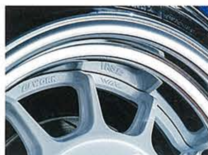
アーチラインに対してのバランスも考慮して205/45R16を履くイーブライム・EK4は、スポークディッシュとタイヤの逞しで足元を引き立てたシンプルレーシーな1台。タイヤ外径から生まれる腰高感は車高の低さでカバーすべく、フロント9J×16+20、リア9J×16+15の引っ張りマッチングによってクリアランスを確保している。
