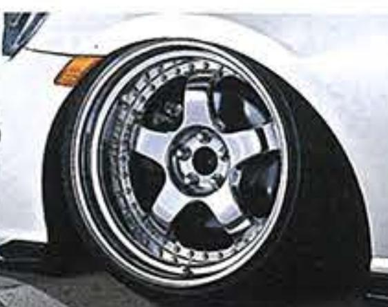
エアサス装着車は「どの車高にフォーカスするか」がセッティングのポイントになる。当車は車高を下げた状態でリムツラ、前後14度のネガキャンになるよう仕上げた。フロントはメガアンレーシングのロワアーム+プラケットの長穴加工、リヤはクスコの調整式アームを用いている。車高を上げればストレスなく走れるセッティングもポイントだ。
