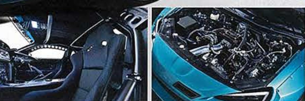
シリアルナンバープレートが誇らしげなHKS2.2lショートブロックエンジン。ポンネット、ルーフ、トランクは米マーシュコンボジット社のハニカム仕様ドライカーボン製、ドアはレボリューションのカーボン製を導入している。車内ではワンオフしたサイトウロールケージ製ロールケージが目立つ。ガセットを追加した上で「溶接風」を演出。フルバケ2脚で2名乗車公認を取得している。
