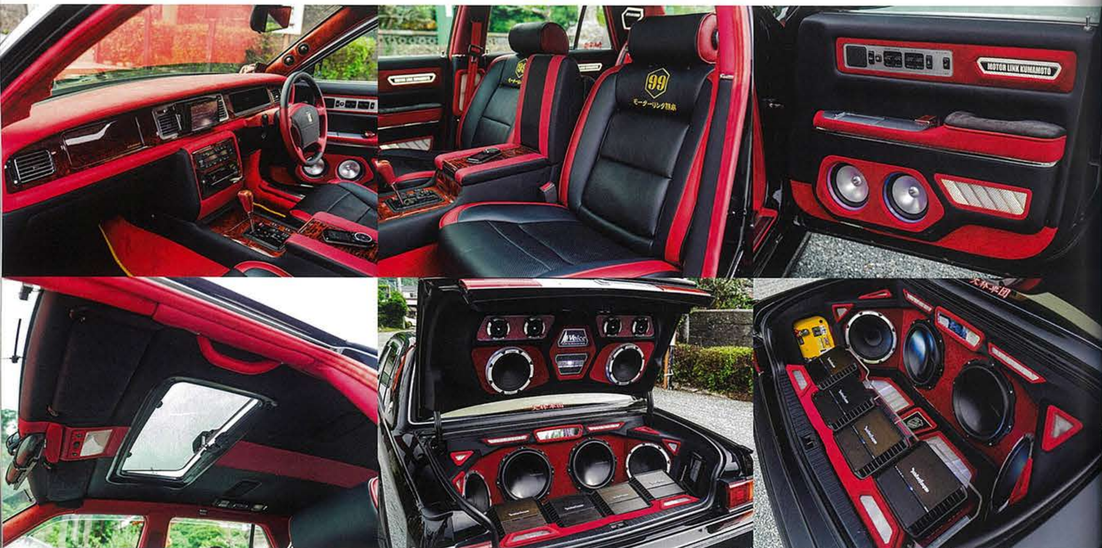
定番の赤×黒仕様だが、ダッシュはアルカン、シート中央はパンチングを使うなど質感で変化を出す。室内のあらゆる場所にLEDが仕込まれており、夜も強烈に目立つ。機器類はロックフォードで揃えた。
