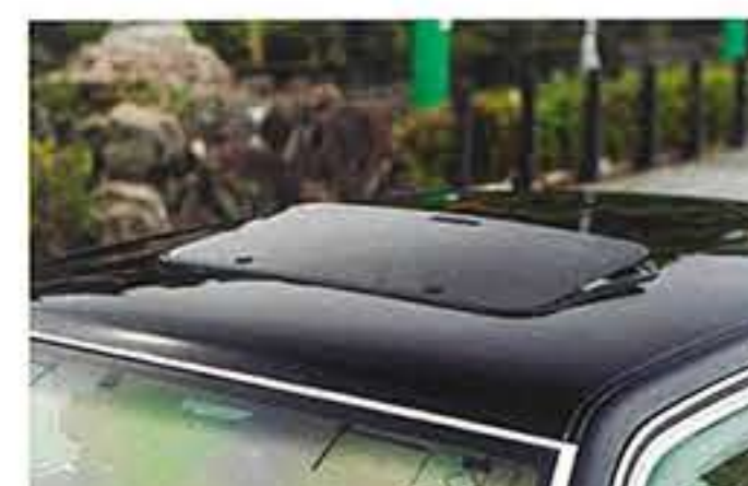
センチュリーの施工例はなかなか珍しい後付けサンルーフ。手動式だが雨漏りもなく安心して使えている。
