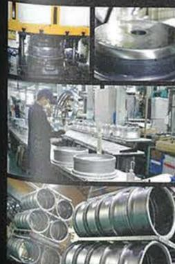
岡山第二工場では、NC旋盤のスピンニング加工によって一枚のアルミ板から絞り出すようにしてリムを製作。継ぎ目のないリムは、抜群の強度を誇る。3ピースホイールの場合、インナーリムとアウトナーリムのサイズの組み合わせ次第で、様々なインセットを実現することが可能だ。
