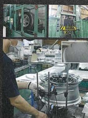
ワークでは徹底した品質管理を行なっている。完成品の検査はもちろんだが、製造工程において実施されるマイクロゲージを使った精度チェック、締め付け精度の徹底など、手間ひまを惜しまない徹底した品質へのこだわりは特筆ものだ。
