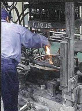
岡山第二工場ではアルミのインゴットを精錬し、低圧鍛造製法で3ピースホイールのディスクを製作。不純物を徹底的に取り除き、アルミ分子の均一化を実現するなど、材料レベルからこだわり抜く。これが高い強度へと繋がっている。
