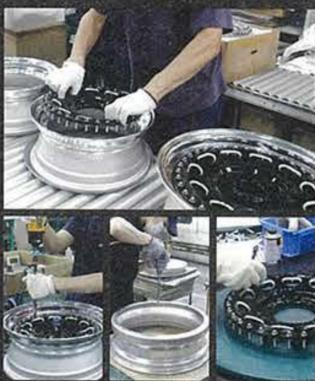
高い組立精度が要求される3ピースホイール。一連の工程には熟練した技術者の匠の技術が不可欠。またパーツを組み立てるのではなく、真円精度を確認しながら作業は行なわれる。
