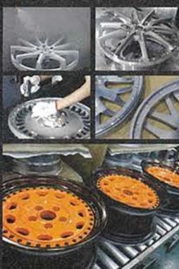
鍛造後に熱処理を行ないさらに強度を高められたホイールは、塗装や磨きに向け、シット加工や余分な部分の切削が行なわれ製品の形となる。塗装や磨きは、別工場での熟練の職人によって実施。多くの人の手を経ることによって、CRAGは産み出されている。
