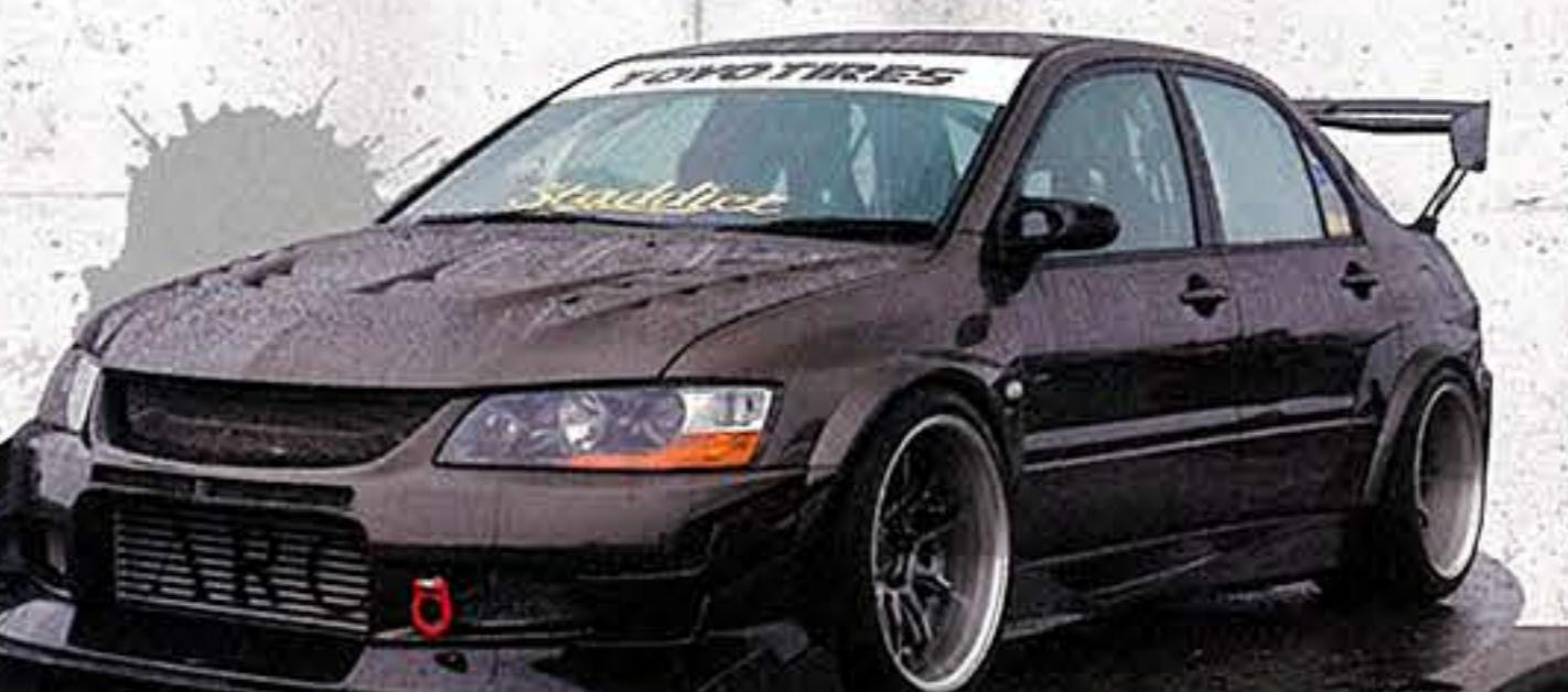
“現代のワイスビ”をテーマに、日々カスタマイズを施す新野サンのランボVII。ボルテックス・サーキットver.に、エモーションZR10 2P (18×12J) を投入する。ボンネットを開ければ、2.2l化したパワードエンジンが君臨する非の打ち所がない1台だ。
