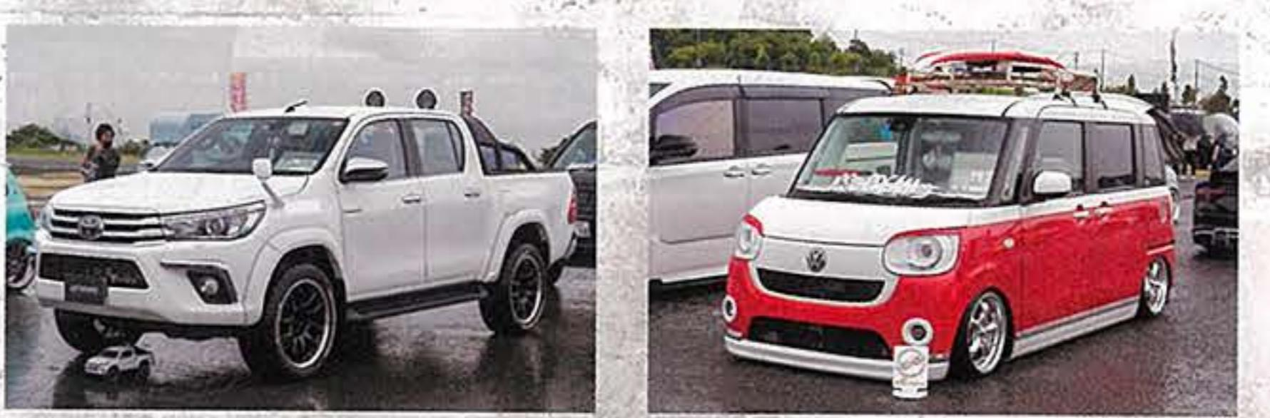
125系ハイラックス前期型に対し、エモーションCR SUV (20×9J) に、モンスター・トレーニングリッパー (265/50) をセレクトした細身サン。オバフェンは海外純正TRD製で、荷台にはTRD純正ロールバーを装着。
