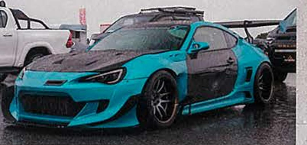
パンデムのボディキットにバトルエアロのスワンネックを装着した奥原サンの86。エモーションCR2P (18×10.5J / 12J) をマウントする。エンジンは世界10機限定の2.2l仕様。HKSタービンで400馬力を発生する。
