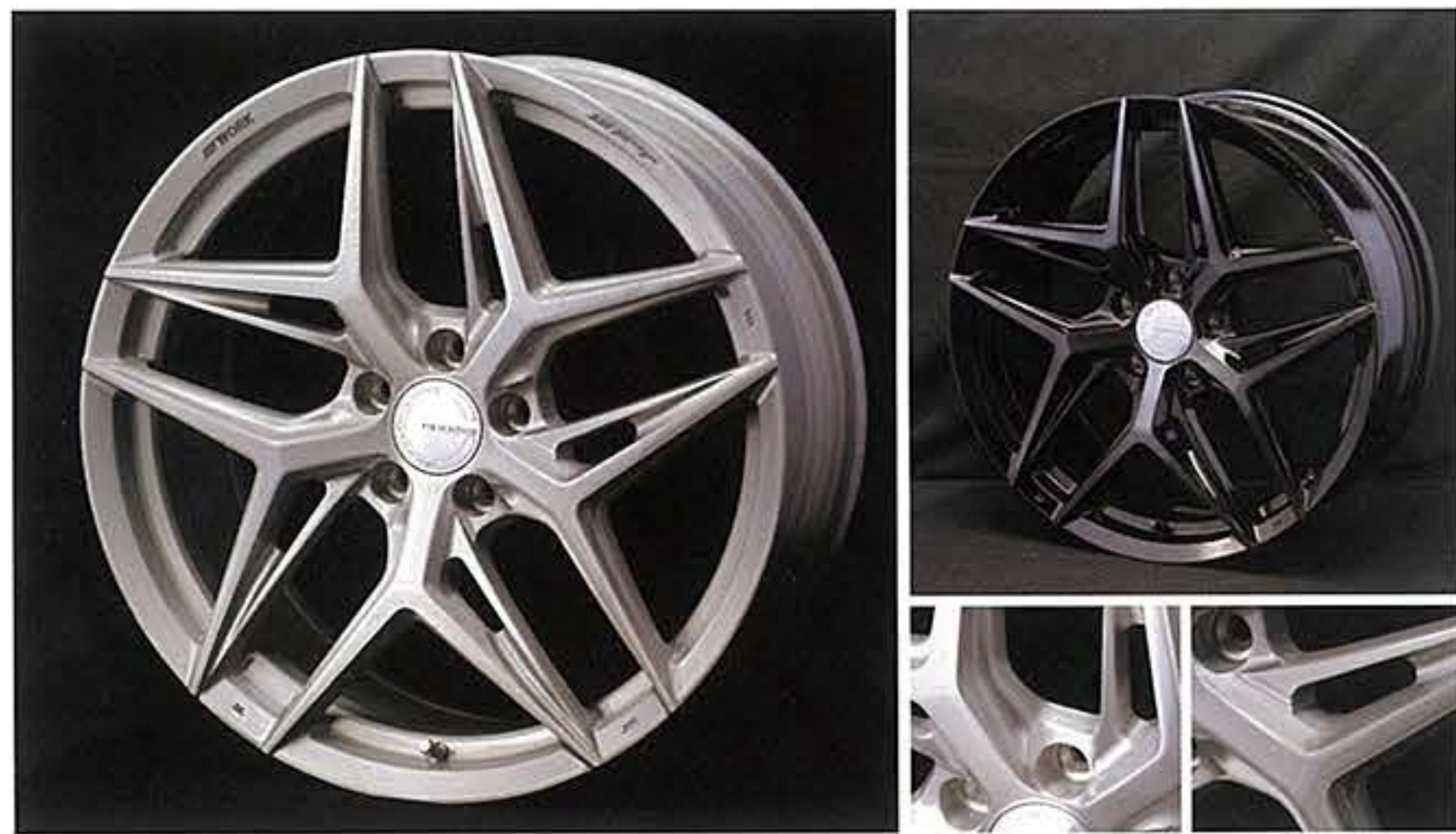
GNOSIS IS205 インタビューでも挙がっていたワークが誇る世界最高峰の技術 WFT により製造される輸入車対応ホイール。WFT=ワークフォーミングテクノロジーとは鍛造が完了した素材のリム部分に圧力を掛けながら伸ばして成型する製法。鍛えられたアルミ組織の微細化による「しなやかさ」と肉薄化がもたらす「軽量化」を高い次元で両立させている。19 / 20 / 21 インチを設定。
