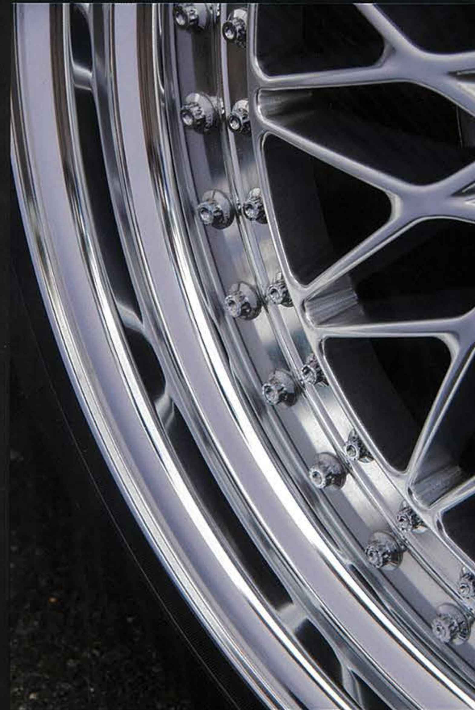
リム（インナー、アウター）とディスクで構築されるマルチピースホイールは、今ではワークならではの個性となった。素材や加工方法などを研究し尽くした上に成立する、独特の光沢や質感を持つフィニッシュも見ものだ。
