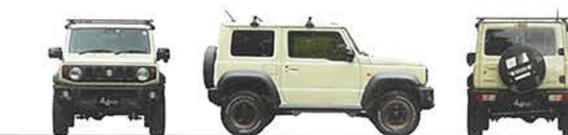
ベース車両は2.5インチアップしたジムニーシエラ。リフトアップとホイール&タイヤ交換だけで、ここまでオフスタイルにイメチェンできるというカスタムのお手本だ
