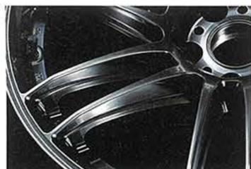
鍛造ホイールのようなスリムさに仕上げられたスポークは、フランジ剛性を高めるためにスポークエンドでフランジを押しあわせるようにデザインされている。
