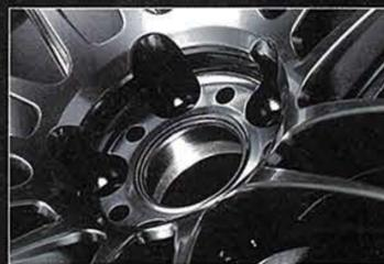
センターハートはZR10でも採用されたアンダーカットやホールによる軽量化が施されている。一切の駄肉を許さない削ぎ落としの痕跡は立派な造形美のひとつだ。
