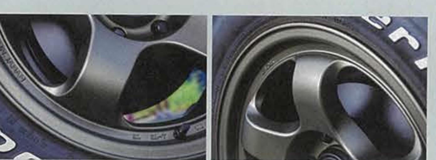
JWL-T認証取得のために厚みが引き上げられたスポークは3つのコンケイブを持ち、MAX53mm深度のセンターパートと展開。過酷なオフロード走行を支えるリップ構造のディープリムとあわせて、足もとの深みを全方位へ押し出していく。
